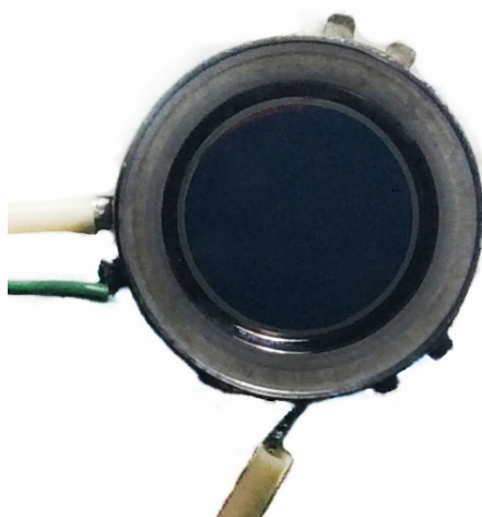
Рис. 6: Арсенид-галлиевый фотокатод, исследуемый в данной работе
