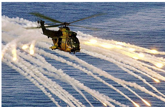
Рис. 1: Защита вертолётa тепловыми ловушками
